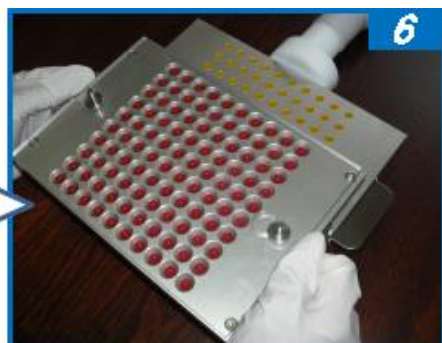
6.キャッププレートを外します
