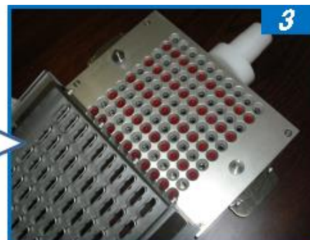
3.カプセルがすべて上向きにそろってセットされます
