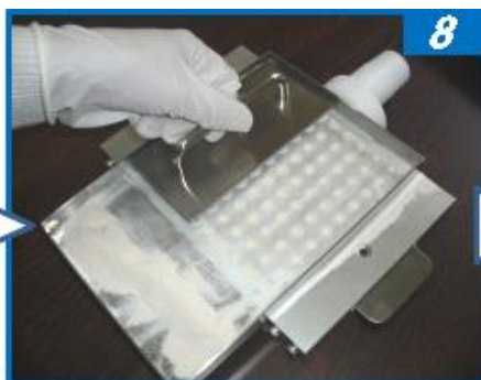
8.タンパーで押し固め 再度充填
